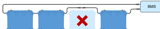
Het verhelpen van een BMS-fout door een vermoedelijke defecte accu over te slaan
